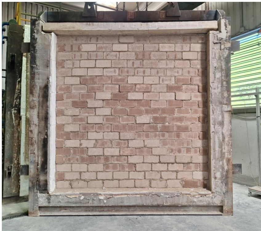
Fotografía 18: Aspecto de la cara expuesta después del ensayo (cara expuesta al fuego).
