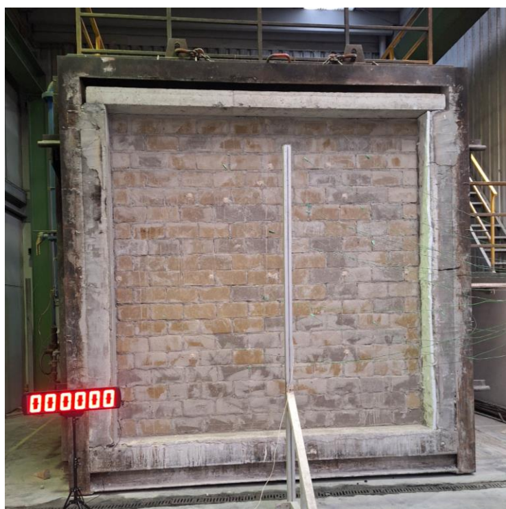
Fotografía 9: Aspecto de la muestra antes del ensayo, cara no expuesta.
