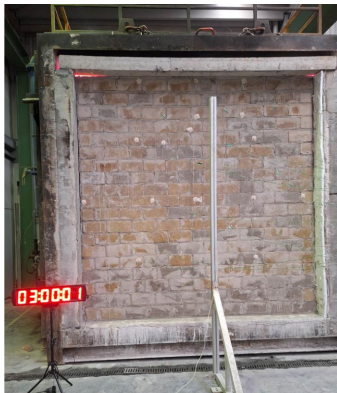
Fotografía 17: Aspecto de la muestra en los momentos finales del ensayo.
