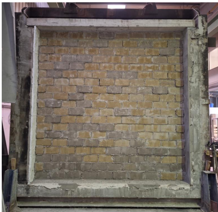
Fotografía 9: Aspecto de la muestra antes del ensayo, cara no expuesta.
